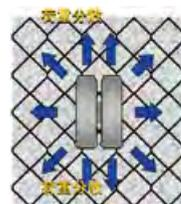
ジオウエップによる充填材の拘束効果、及びセル壁面の摩擦抵抗により荷重が分散し、わだち掘れ発生を抑制します。
