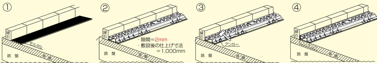
① 施工面にモルタルを敷均し、不陸を解消して下さい。
