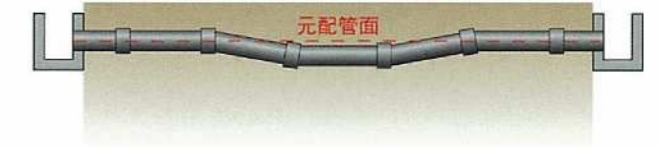
継手部による不同沈下への追従例
